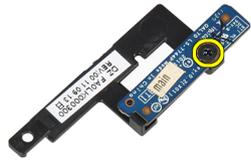
7. Retire a placa de LED da chapa de suporte da placa de LED.
