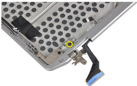
4. Faça deslizar e retire do conjunto do ecrã a parede esquerda das dobradiças do ecrã.
