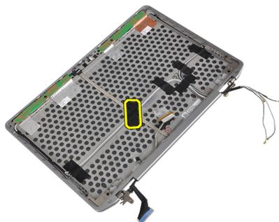
4. Desligue o cabo da câmara do módulo da câmara e do microfone.
