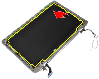
6. Descole a fita do conector do cabo LVDS e desligue o cabo LVDS do painel do ecrã.
