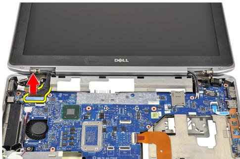
9. Puxe os cabos de antena da abertura na placa de sistema.
