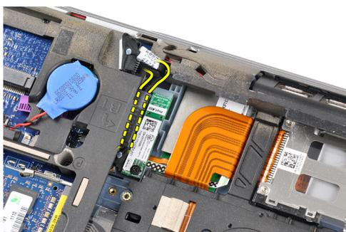
6. Retire o parafuso que fixa o módulo Bluetooth ao computador.
