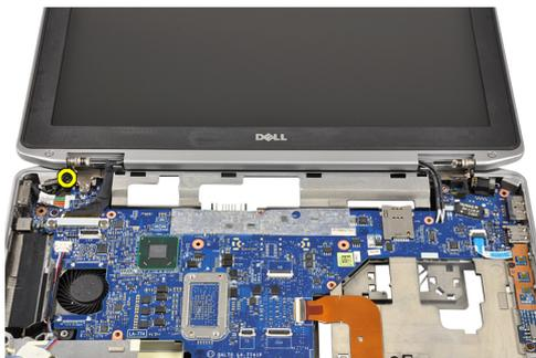
6. Retire os parafusos que fixam o suporte de fixação do LVDS (Low-Voltage Differential Signaling).
