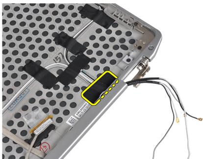
6. Retire os cabos de antena da abertura na parede direita das dobradiças do ecrã.
