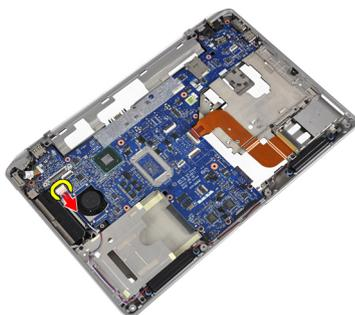
6. Retire os parafusos que fixam a placa de sistema ao computador.
