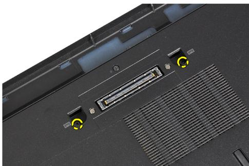
5. Retire os parafusos que fixam o teclado ao conjunto do apoio para as mãos.
