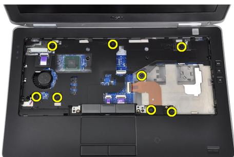
**5.** Desligue o cabo da placa de LED da placa de sistema.
