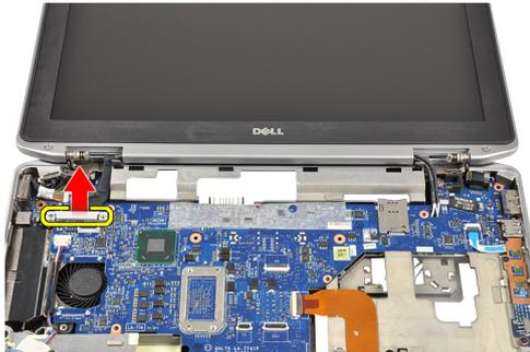
8. Desconecte o cabo de LVDS da placa de sistema.
