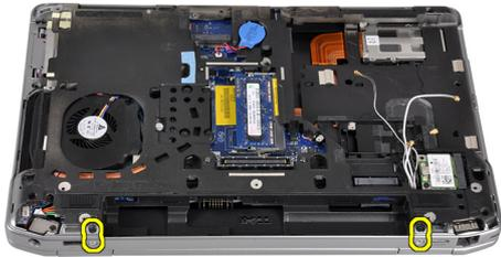
5. Retire o parafuso que fixa a dobradiça esquerda do ecrã ao computador.
