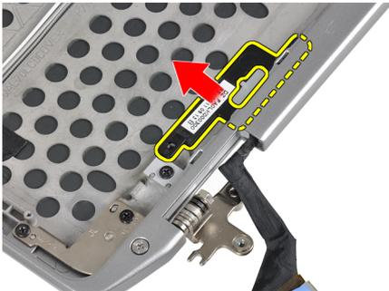
5. Desligue o cabo da placa de LED da respectiva placa.
