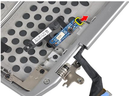
6. Retire o parafuso que fixa a placa de LED à chapa de suporte da placa de LED.
