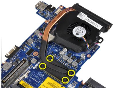
5. Retire o dissipador de calor da placa de sistema.
